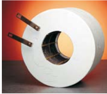
Abb. 2 RAC Rohre mit eingebettetem, jedoch annähernd freistrahendem Heizelement, für eine maximale Elementtemperatur von 1300°C
