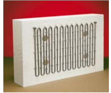
Abb. 3 Meanderthal II-Module mit freistrahenden Heizelementen für eine maximale Elementtemperatur von 1300°C, überwiegend für Decken und kippbare Öfen
