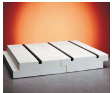
Abb. 7 FibroSiC sind freitragende Decken-Isolierteile, die durch SiC-Rohre verstärkt sind
