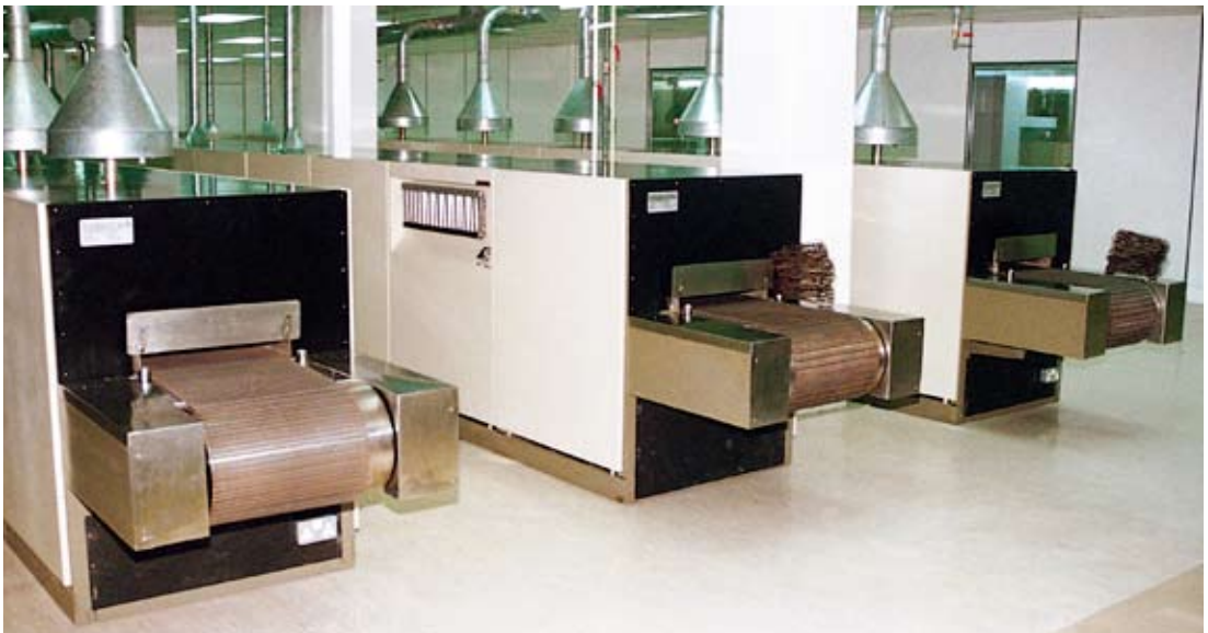
Abb. 32 FIBROTHAL Module, eingesetzt in einem Förderbandofen
